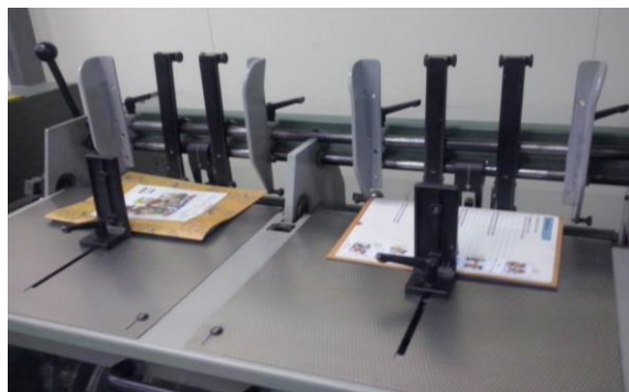
FIGURA 1 - Nesta imagem, se tem uma das estações da máquina grampeadeira, existem reguladores a qual são as bases para que as folhas possam ser alocadas e assim sugadas por sistemas de ar para seguir à esteira.
