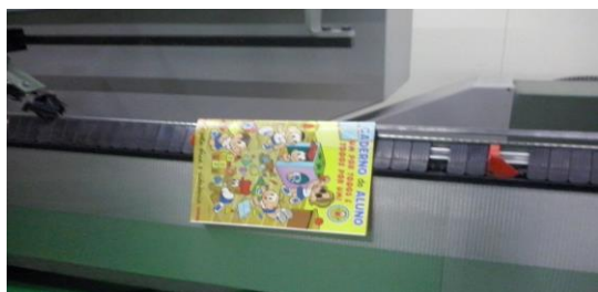
FIGURA 2 - Esteira que leva partes das revistas a segunda estação onde outras páginas caem pelo sistema de ar.
