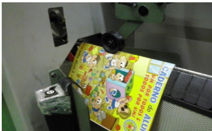
FIGURA 3 - Sistema poka-yoke integrado a grampeadeira. Nesta imagem observa-se o momento em que a revista passa pelo sistema poka-yoke , o sistema está regulado para que a revista tenha uma aceitação por espessura.
